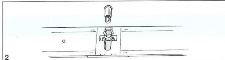
Glühlampe mit Steckfassung (6535) in den Lichtleiter **c** einsetzen.
