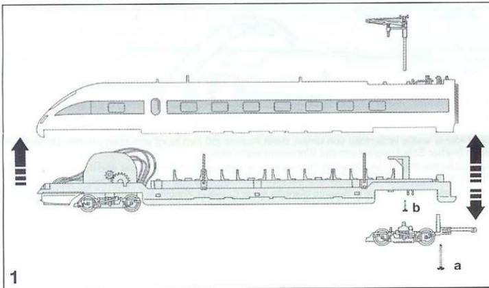
Zunächst die Schraube **a** entfernen und das hintere Drehgestell abnehmen. Danach die Schraube **b** entfernen, damit der Pantograph samt Halterung abgezogen werden kann. Jetzt kann das Gehäuse senkrecht nach oben abgenommen werden.
