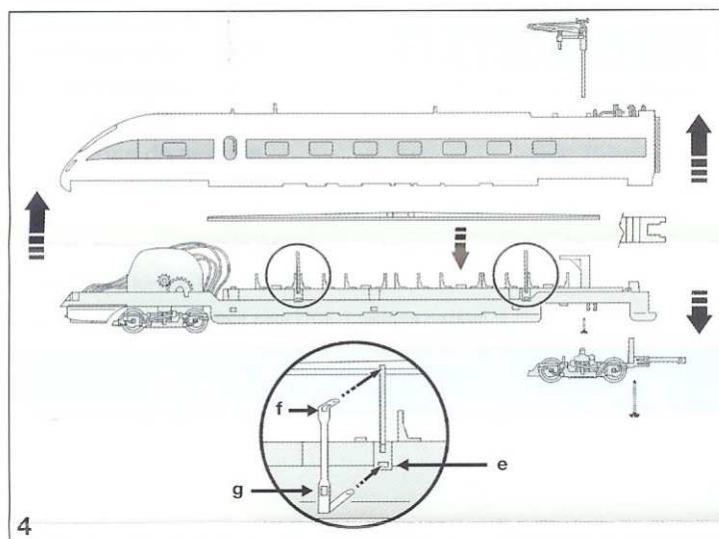
Den Lichtleiter auf die Inneneinrichtung legen. Die Kontaktbügel sorgen für festen Halt des Lichtleiters auf der Inneneinrichtung und versorgen diesen mit Spannung. Zuerst den Kontaktbügel unten in die Aussparung **e** der Inneneinrichtung locker einstecken, dann am Zapfen **f** einhängen. Kontaktbügel ein wenig nach unten ziehen und am Vorsprung **g** einrasten.
