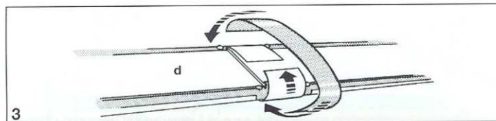
Zuerst kleine weiße Isolierfolie von unten, dann Alufoilie (60 mm lang) von oben um den Lichtleiter **d** kleben (vorher Schutzpapier von der Klebeseite entfernen).
